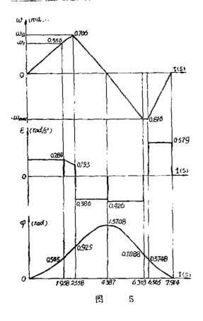
由式(10) 得 $M = 71534(N \cdot m)$ ,由式(9) 得满斗最大转速 $\omega_Q = 0.706$  (rad/s),相应的  $\omega_L = \frac{\omega_{max}}{R} = 0.556(rad/s)$ ,回转循环时间按式 (7)得T = 7.974 (s),转台回转的运动特性 见图 5.
