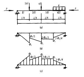
图 4 变截面梁柱的刚度、曲率及曲率荷载
