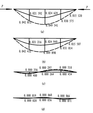
图 6 一阶变形的分解及放大后的二阶变形
