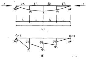
图 1 变截面梁柱的刚度、挠度和曲率
